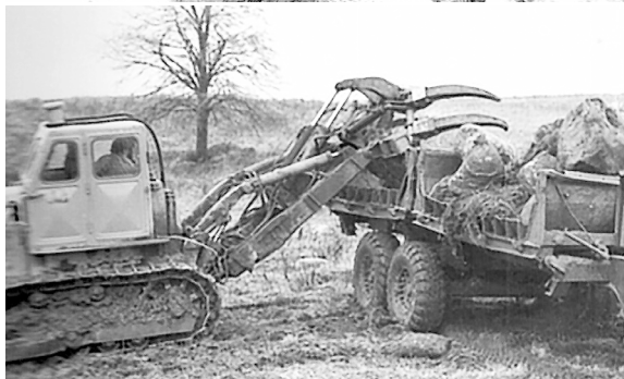
1 pav. Akmenų šalinimas iš laukų melioruojamose plotuose. XX a. 8–9 dešimtmetis (žurnalo „Žemėtvarka ir melioracija“ redakcijos archyvas).
